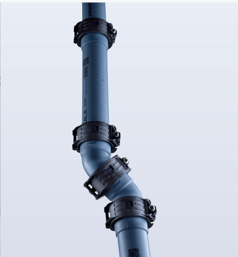
POLO-KAL® hat sich als Stecksystem im Hausabfluss seit mehr als 60 Jahren bewährt und zeichnet sich auch in der Anwendung als Druckleitung für Hebeanlagen und Tauchpumpen aus. Die Auszugsicherungen POLO-KAL XS ASV und POLO-KAL NG ASV von POLOPLAST ermöglichen eine nicht dauerhafte Druckbeaufschlagung der Rohrleitung von bis zu 2,5 bar. Dadurch sind Druckleitungen bis DN 90 problemlos realisierbar.
